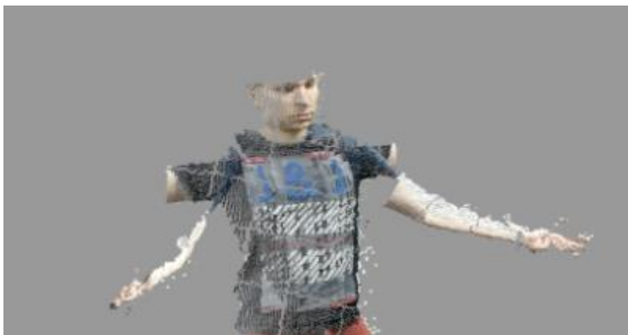
Figuur 62: Incorrecte instellingen bij de stralen kunnen fouten opleveren voor de herkenning.
