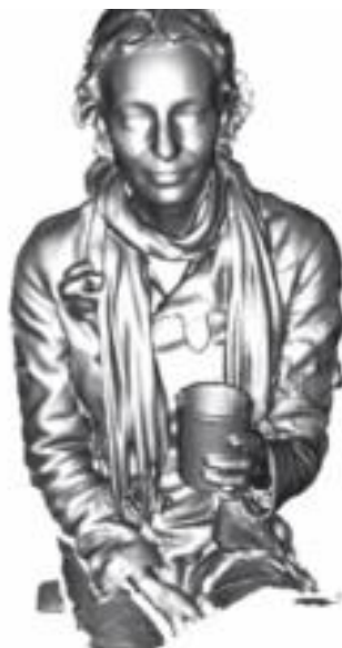
Figuur 79: Hoge kwaliteit reconstructie door middel van DynamicFusion. (Newcombe et al., n.d.)
