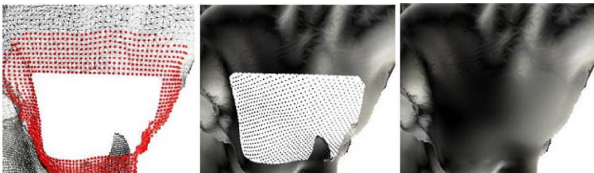
Figuur 20: Hole Filling; Ontbrekende data wordt ingevuld door polygoenen bij te voegen. (Brook & Alegre, n.d.)
