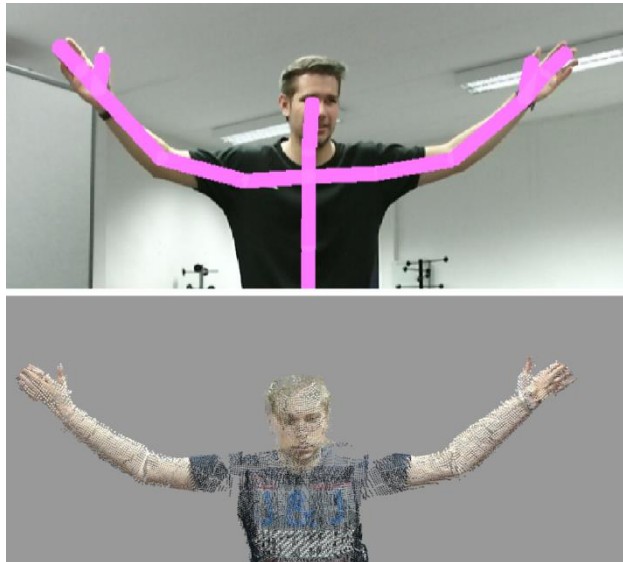
Figuur 75: Een remapping van een opname. De opname aan de onderkant wordt gemapped op de persoon zoals die zichtbaar is voor de Kinect (onder).
