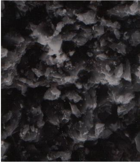
Figuur 1: actieve kool onder een elektronenmicroscop [16]
