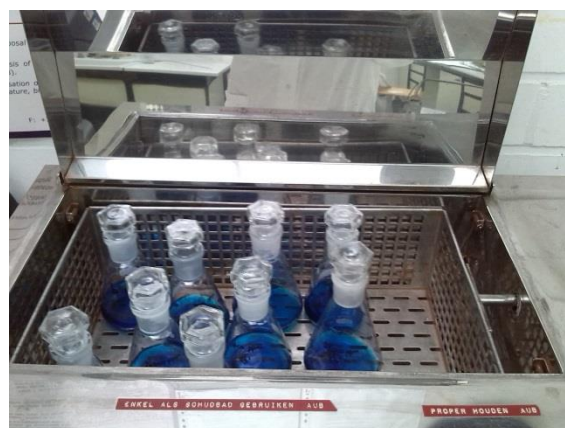
Figuur 15: schudbak, gebruikt voor de experimenten met AC/perMOX en perMOX (binnenaanzicht)
