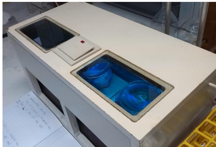
Figuur 11: UV-opstelling met 1 UV-lamp gebruikt voor de experimenten onder UV
