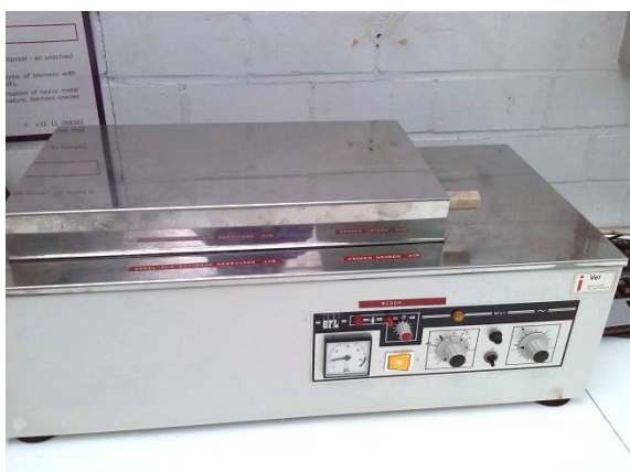
Figuur 14: schudbak, gebruikt voor de experimenten met AC/perMOX en perMOX (buitenaanzicht)
