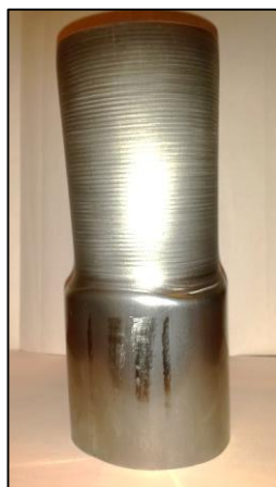
Figuur 88: Eerste testbuis, met duidelijk niet ronde vorm onderaan, afdrukken van de klemmen en aan de bovenkant een licht conisch gereduceerd gedeelte
