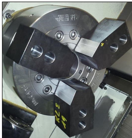
Figuur 80: Klemmen diameter 85 mm
