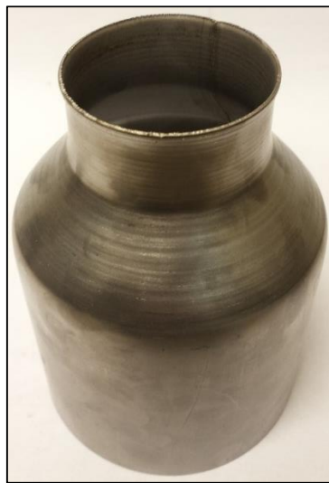
Figuur 95: Buis \varnothing 124 mm, reductie 70 mm en conushoek 40^\circ
