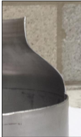
Figuur 133: Open gezaagde buis voor bepaling wanddikteverloop
