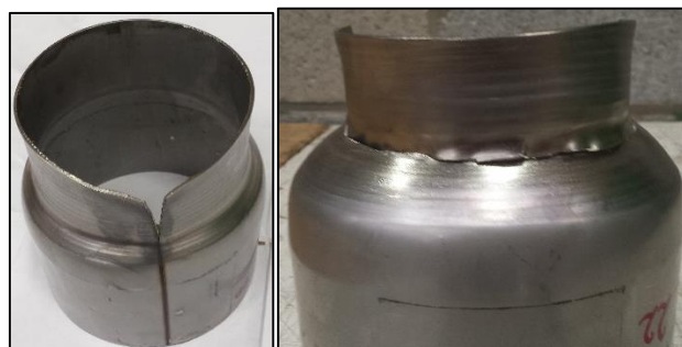
Figuur 125 Defecten bij de buizen 1.4301 wanddikte 1,5 mm
