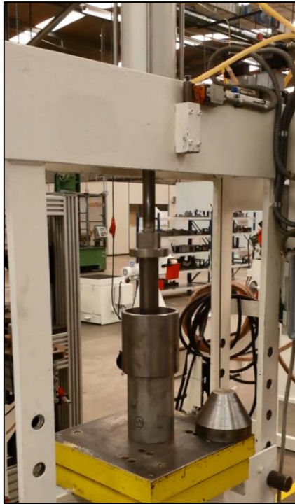
Figuur 70: Pers tijdens het inpersen van een dummykatalysator en mat in een testbuis
