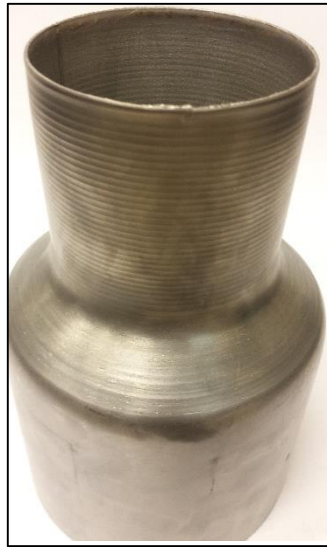
Figuur 97: Buis \varnothing 124 mm met reductie 50 mm en conushoek 50^\circ
