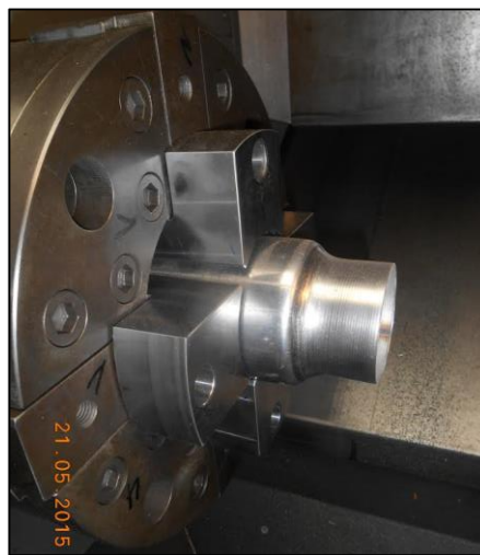
Figuur 84 Optimale klemmen met buis
