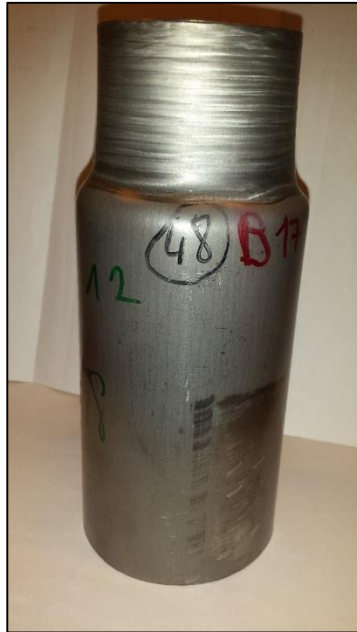
Figuur 92: Testbuis met aan de onderkant duidelijke markeringen van de klemmen
