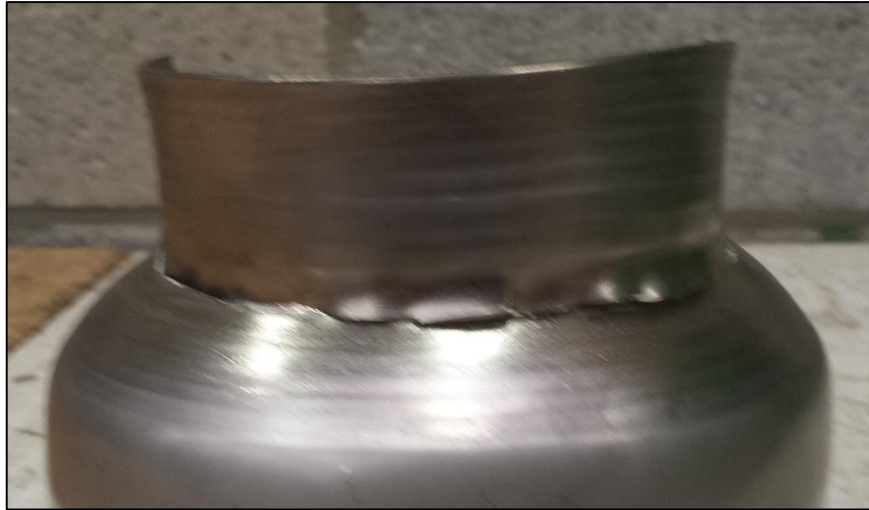
Figuur 143: Scheur op overgang van conus naar recht gedeelte bij materiaal 1.4301
