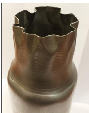
Figuur 89: Testbuis \varnothing 85 mm met wanddikte 0,8 mm met ernstige rimpelvorming over het volledige gereduceerde gedeelte
