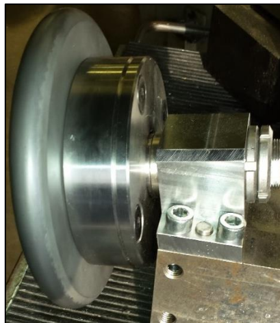
Figuur 78: Vervormingsgereedschap gemonteerd op gereedschapshouder
