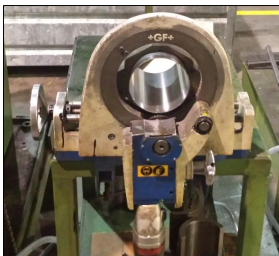
Figuur 67: Zaaggereedschap om buizen recht door te snijden
