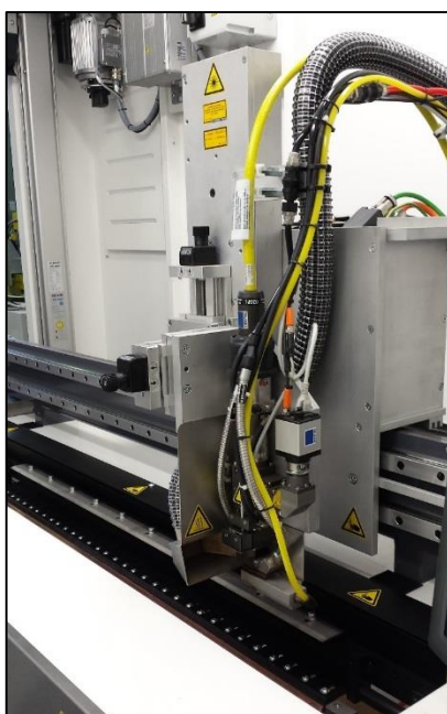
Figuur 72: Laserlaskop gemonteerd op de slede
