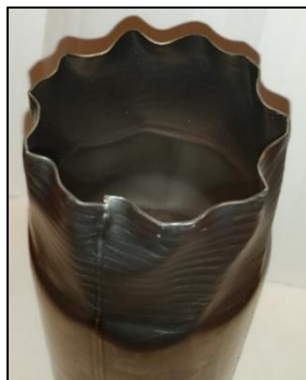
Figuur 90: Buis met rimpels en kleine scheur aan het begin van de lasnaad
