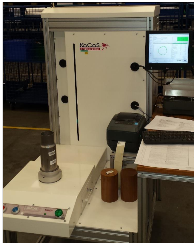
Figuur 87: Lasermeetmachine voor de diameter en rondheid
