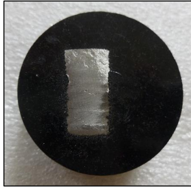
Figuur 144: Testblokje ingebed in thermohardende kunststof
