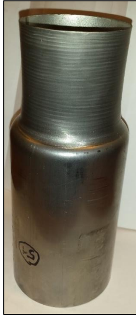
Figuur 91: Goed eindresultaat ( \varnothing 85 mm, conushoek = 60^\circ )
