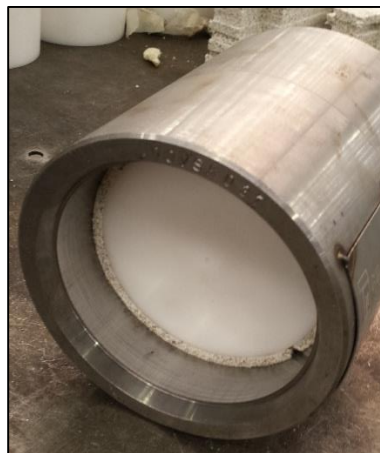
Figuur 69: Dummykatalysator met mat in het conusvormig geleidingshulpstuk
