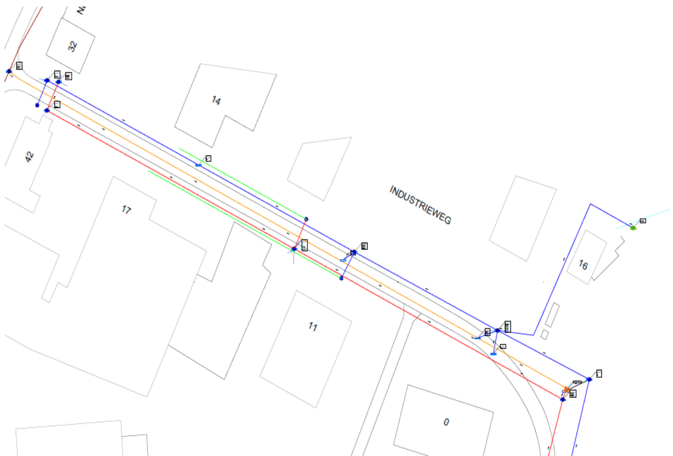
Figuur 39: Voorbeeld oplossing via collectorbuizen 1
