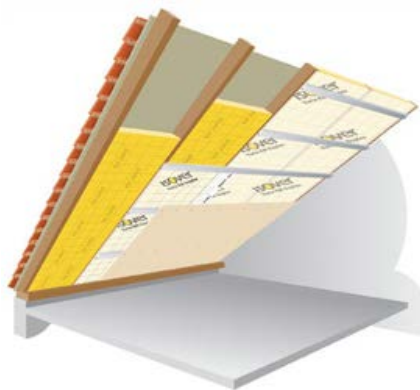
Figuur 8: Opbouw dakisolatie via binnenzijde. [16]
