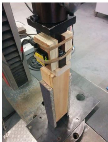
Figuur 83: Proefopstelling belasting evenwijdig met de vezelrichting.
