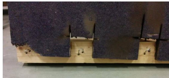
Figuur 45: Bezwijkmode ST1-1 & ST1-2. Nieten vervormen loodrecht op de onderregel.
