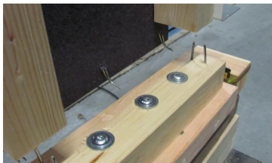
Figuur 47: Bezwijkmode ST3. Uittrekken nieten.
