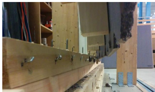
Figuur 48: Bezwijkmode ST4. Buiging en doorponsing nieten.
