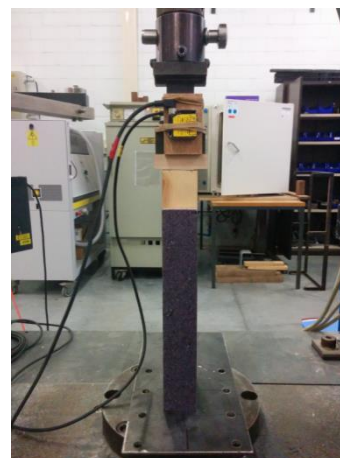
Figuur 84: Proefopstelling belasting evenwijdig met de vezelrichting.
