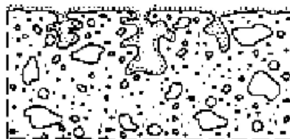
Figuur 19: Schematische voorstelling van hydrofobe impregnering (29)
