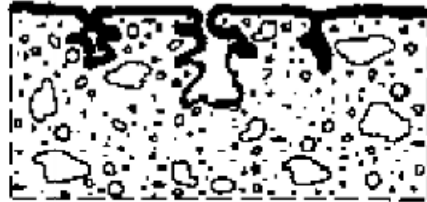
Figuur 20: Schematische voorstelling van een impregnering (29)
