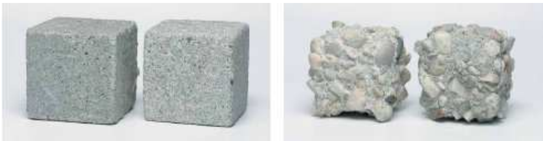
Figuur 7: Beton in zure omgeving: links pH1 en rechts pH0 (14)
