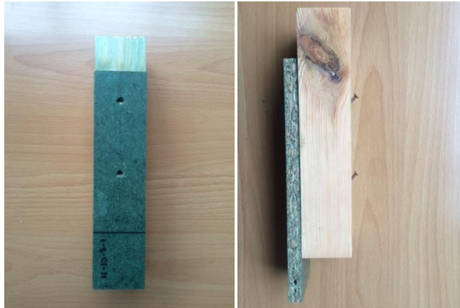
Figuur 94 Toestand genagelde proefstukken met randafstand 10d
