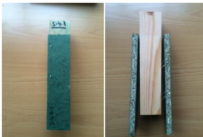
Figuur 111 Toestand geniete proefstukken met randafstand 4d
