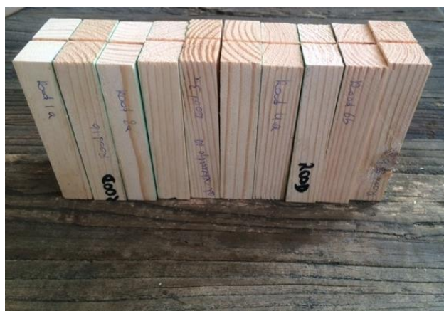
Figuur 81 Proefstukken serie 1 stukdruk
