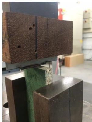
Figuur 32 Testmethode stuikdruk in het kader van dit onderzoek
