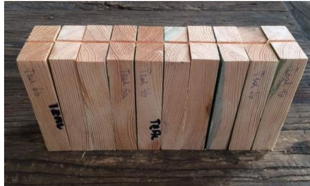
Figuur 88 Proefstukken serie 4 stuikdruk
