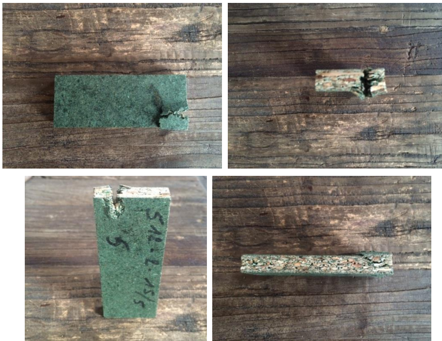
Figuur 42 Brosser breuk proefstuk 5 randafstand 5d - 15d bij \varnothing 2 mm
