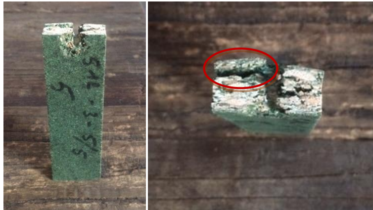
Figuur 47 Uitzicht proefstukken spaanplaat 5d -5d na de test bij \varnothing 3 \text{ mm}
