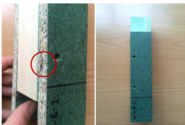
Figuur 100 Toestand genagelde proefstukken bij randafstand 3d
