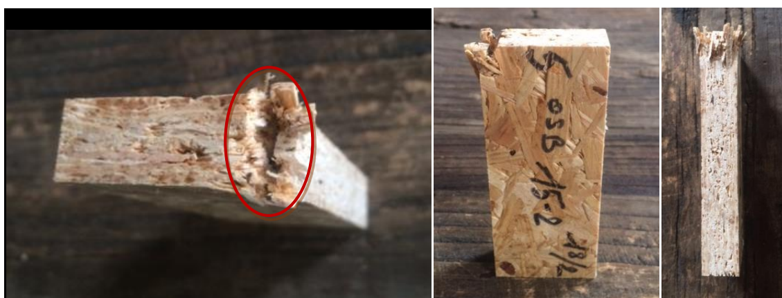
Figuur 63 Brosse karakter proefstukken OSB bij randafstand 2d - 18d
