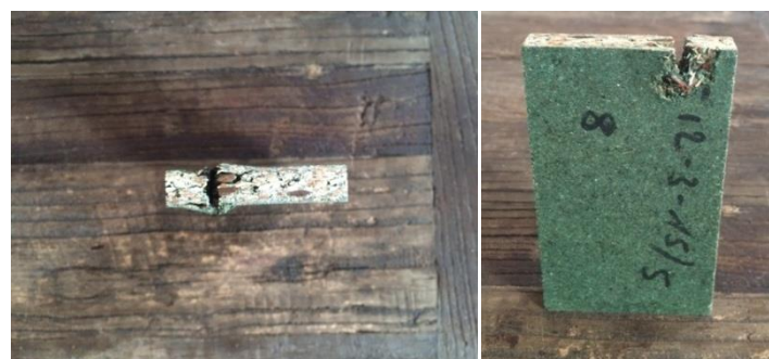
Figuur 43 Uitzicht proefstukken spaanplaat 5d -15d na de test
