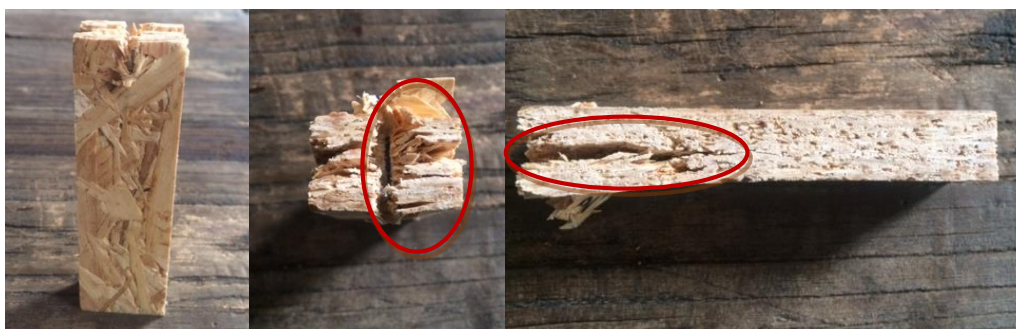
Figuur 60 Brosse karakter proefstukken OSB bij randafstand 5d - 5d met Ø 2 mm
