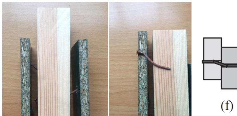
Figuur 116 Bezwijkmechanisme f bij genagelde verbinding serie 1
