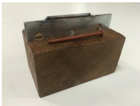
Figuur 79 Test stuikdruk met geprofileerde nagel
