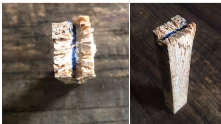
Figuur 65 Falen van plaatmateriaal OSB bij randafstand 2d
