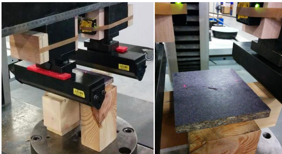
Figuur 70 Proefopstelling uittrekcapaciteit
