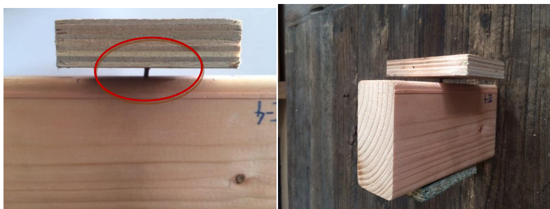
Figuur 77 Toestand proefstukken serie III na uitvoeren test
