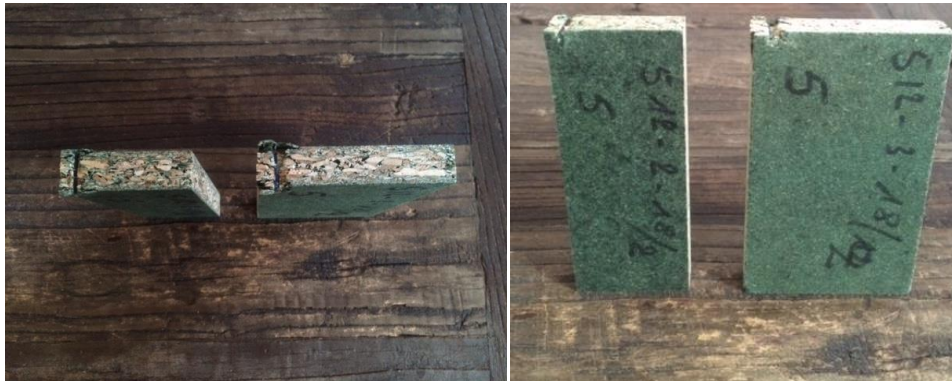
Figuur 50 Uitzicht proefstukken spaanplaat 2d -18d na de test
