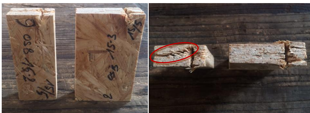
Figuur 57 Uitzicht proefstukken OSB 5d - 15d na de test
