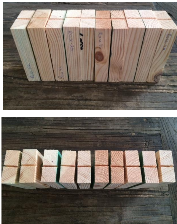
Figuur 83 Proefstukken serie 2 stuikdruk
