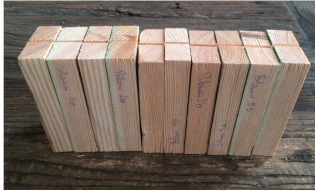
Figuur 85 Proefstukken serie 3 stuikdruk
