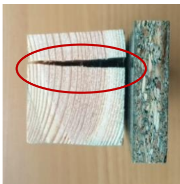
Figuur 127 Splijten van het hout bij onvoldoende eindafstand
