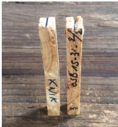
Figuur 64 het knikken van het proefstuk OSB bij randafstand 2d
