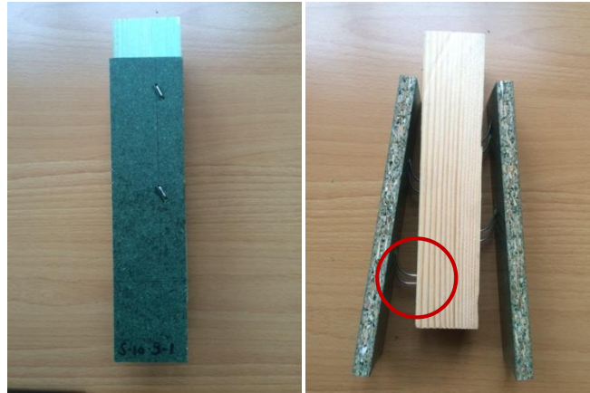
Figuur 105 Toestand geniete proefstukken bij randafstand 10d
