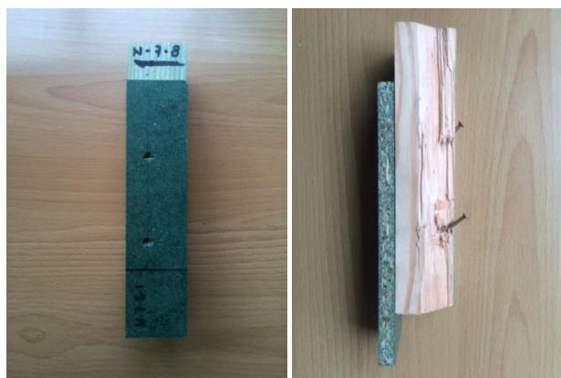
Figuur 96 Toestand genagelde proefstukken bij randafstand 7d
