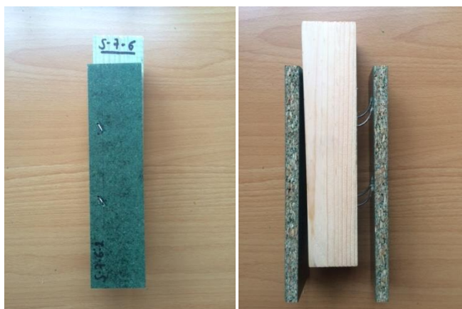
Figuur 107 Toestand geniete proefstukken bij randafstand 7d
