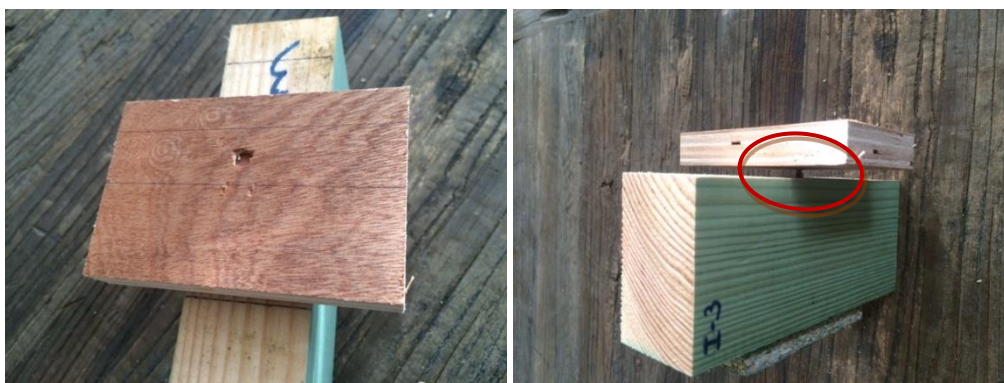
Figuur 73 Toestand proefstukken serie I na uitvoeren test
