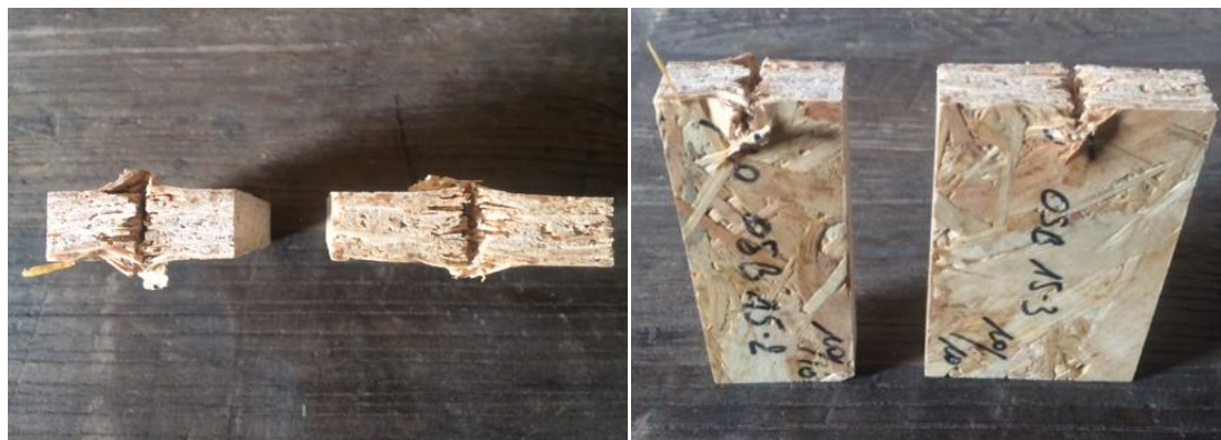
Figuur 54 Uitzicht proefstukken OSB 10d - 10d na de test
