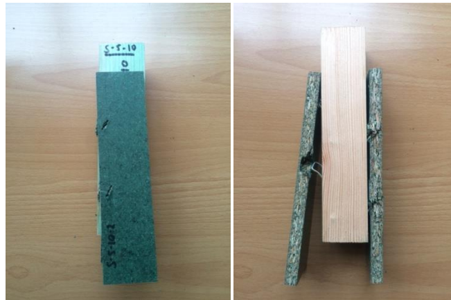
Figuur 109 Toestand geniete proefstukken bij randafstand 5d
