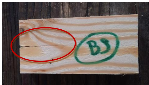
Figuur 87 Splijten van het hout door stuikdruk
