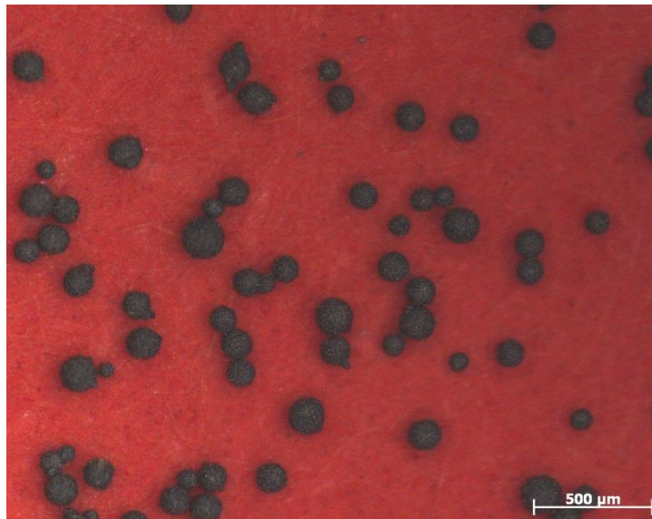
Figuur 27: Foto via optische microscopie van een gesinterd staal
