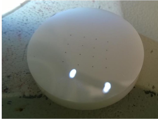
Figuur 18: Ordenen van zuurstofdragers voor druktesten
