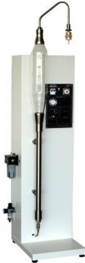
Figuur 20: Opstelling van de attritietest [74]
