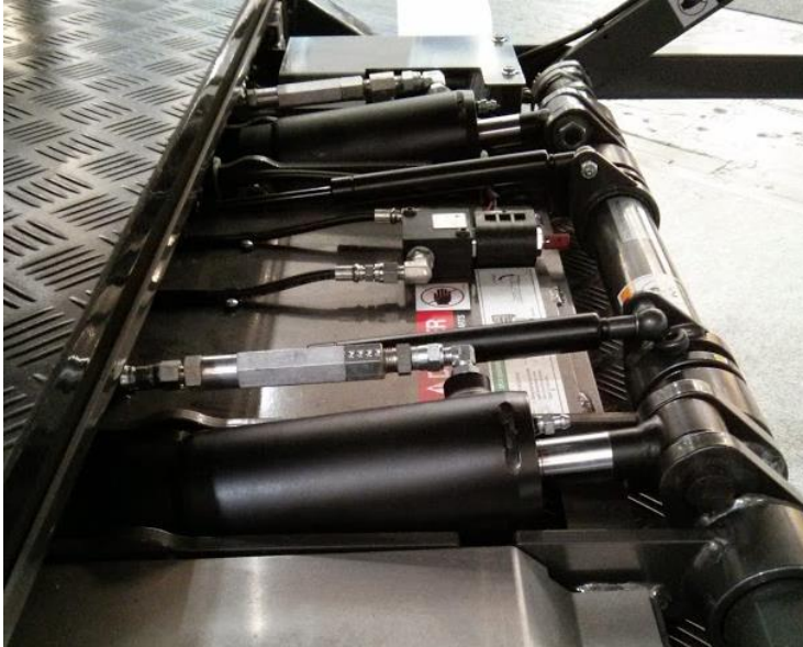
Figuur 34: Principewerking voor rotatie van de armen
