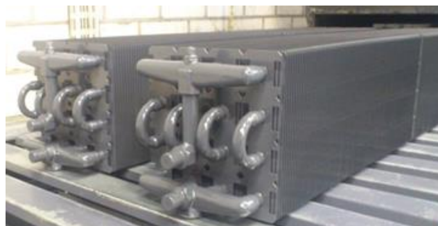
Figuur 27: Warmtewisselaar met messing collector afgewerkt
