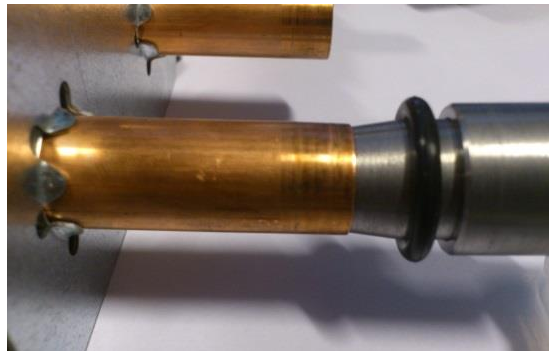
Figuur 54: Assemblage o-ring op koperen buis warmtewisselaar
