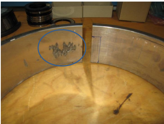
Figuur 51: Zichtbare oppervlakteschade
