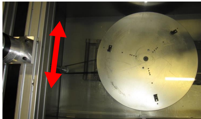
Figuur 23: Opspannen van de riem
