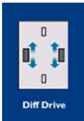
Figuur 19: differentiële sturing [25]
