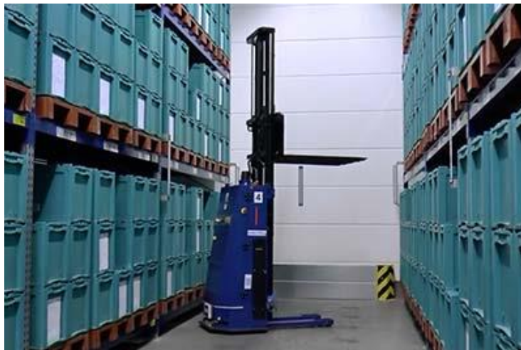
Figuur 5: Voorbeeld van een AGV voor transporteren van palletten[4]
