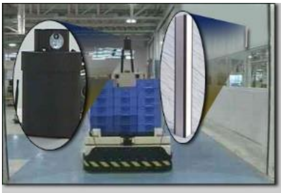
Figuur 26: Lasergeleide navigatie met reflector en laser scanner[33]
