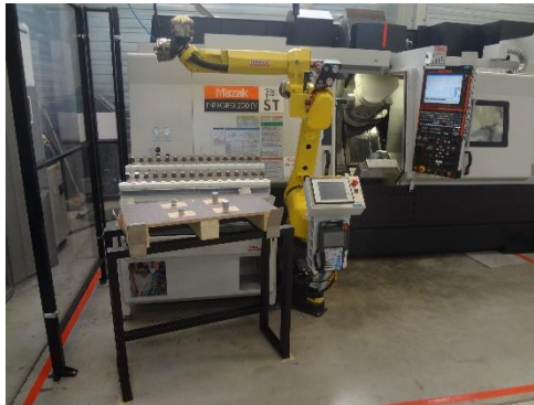
Figuur 40: CNC-cel met beladingsrobot
