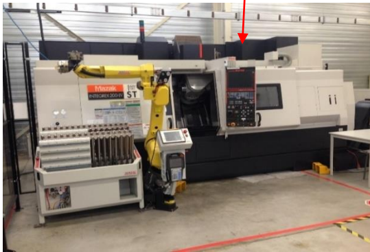
Figuur 3 : Draai-freescentrum met beladingsrobot en magazijn
