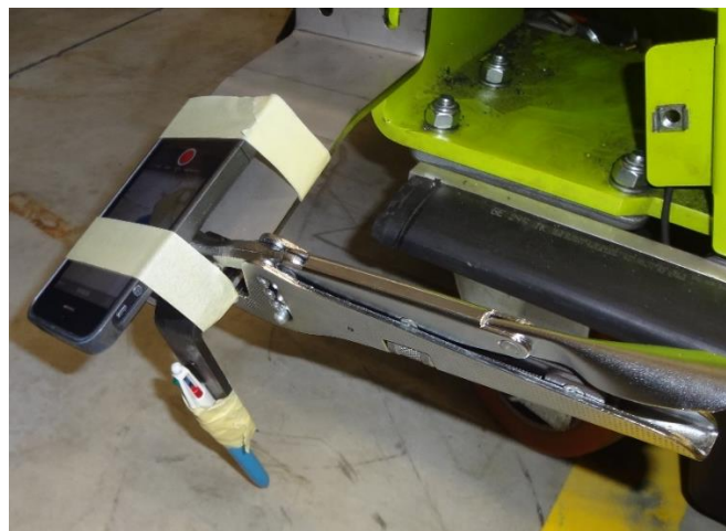
Figuur 33: Constructie op de AGV voor het tekenen van lijnen
