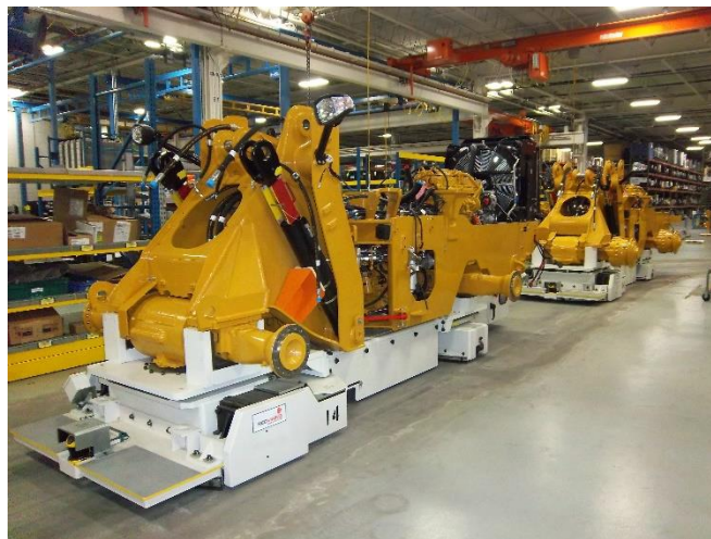
Figuur 11: Custom vehicle AGV met als lading het frame van een bulldozer [14]
