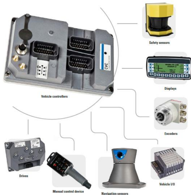
Figuur 18: Componenten aangesloten aan de controller van de AGV[24]
