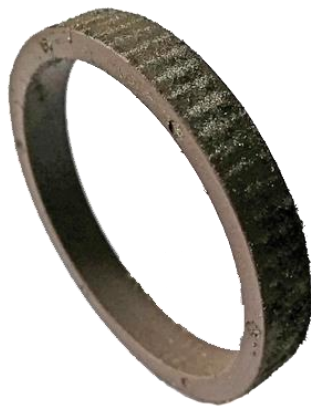
Figuur 26 Visualisatie van de encoderring polen met ijzervijzel
