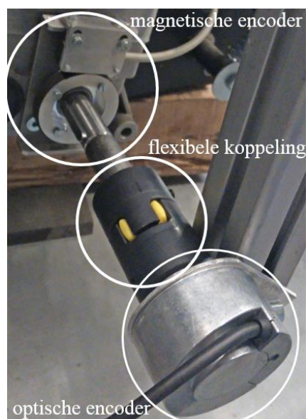
Figuur 20 Ontworpen testopstelling om magnetische encoder en optische encoder te vergelijken
