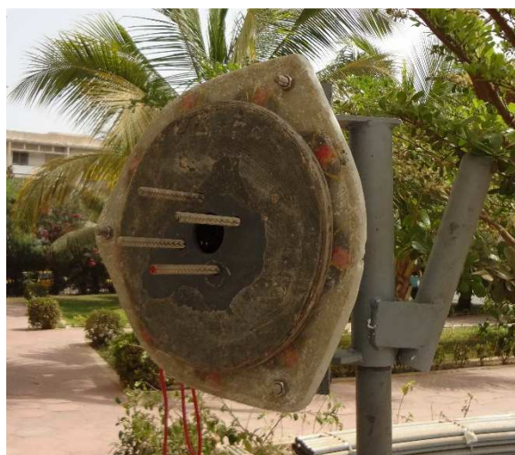
Figuur 36: Generator windmolen 'Futur du Sénégal'
