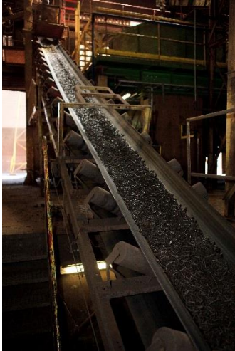
Figuur 9: Transport staafjes naar de oven
