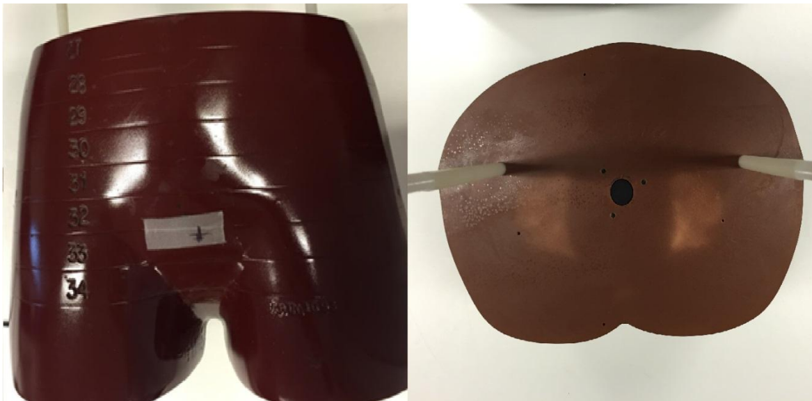
Figuur 20: Bekkenfantoom gebruikt voor het bepalen van de fantoomtransferfout.
