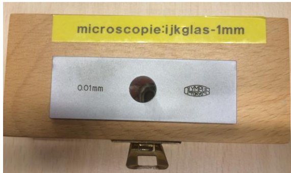
Figuur 23: Ijkglas 1mm met een onderverdeling van 0.01 mm
