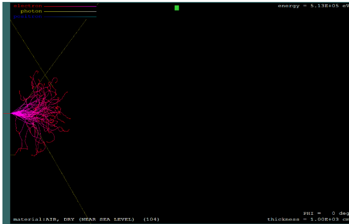
Figuur 4-3: \beta -dracht in lucht voor ^{137}\text{Cs} [eigen simulatie met PENELOPE [25]]
