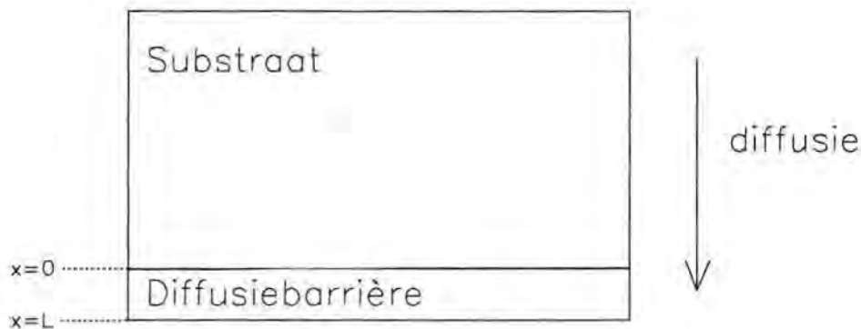
Figuur 1 : Schematische weergave van het te bestuderen diffusiesysteem.
