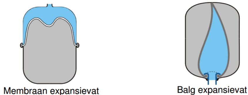
Figuur 52: Principe van een gesloten membraan en balg expansievat [33]
