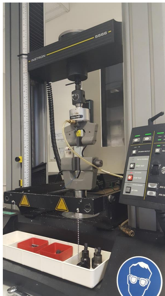
Figuur 88: Instron 5566 trekbank bij CommScope
