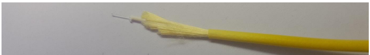
Figuur 76: Opbouw glasvezelkabel 2,4 mm zoals gebruikt in de test
