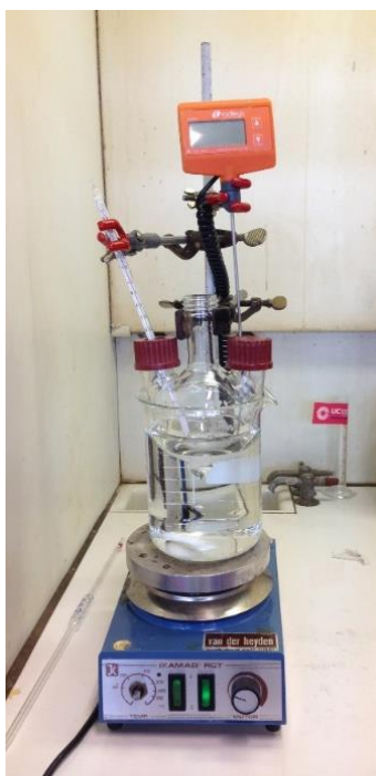
Figuur 39: Opstelling voor de oplosbaarheidsexperiment van N-methylureum in water
