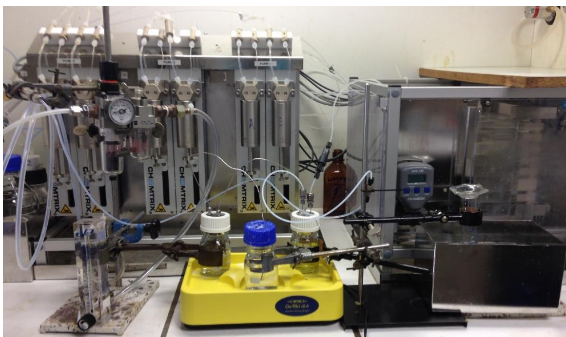
Figuur 48: Opstelling voor de doorborreling met stikstofgas in batch
