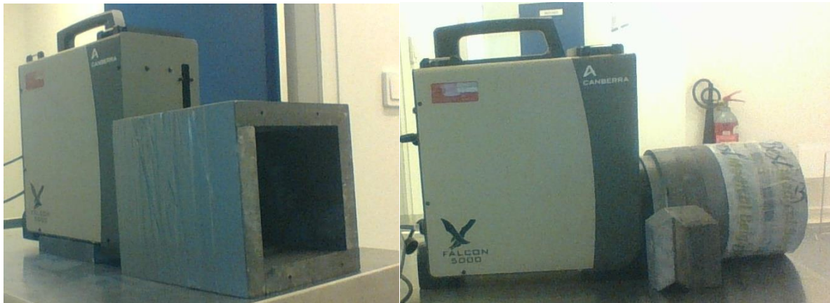
Figuur 24: Balkvormige collimator (links) en cilindervormige collimator (rechts)
