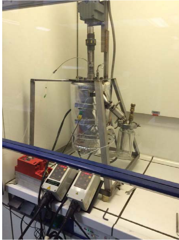
Figuur 15: Opstelling pyrolyse reactor
