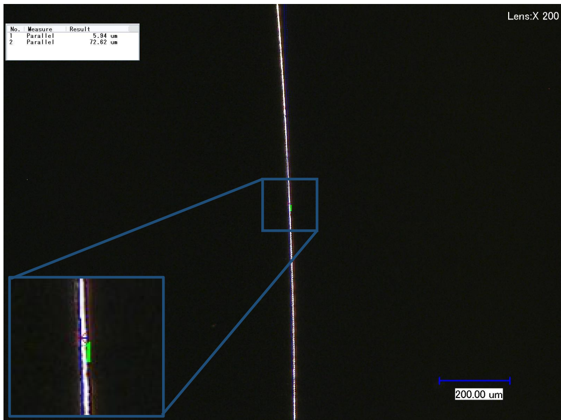
Figuur 22: Meting vloeilijnbreedte met microscoop
