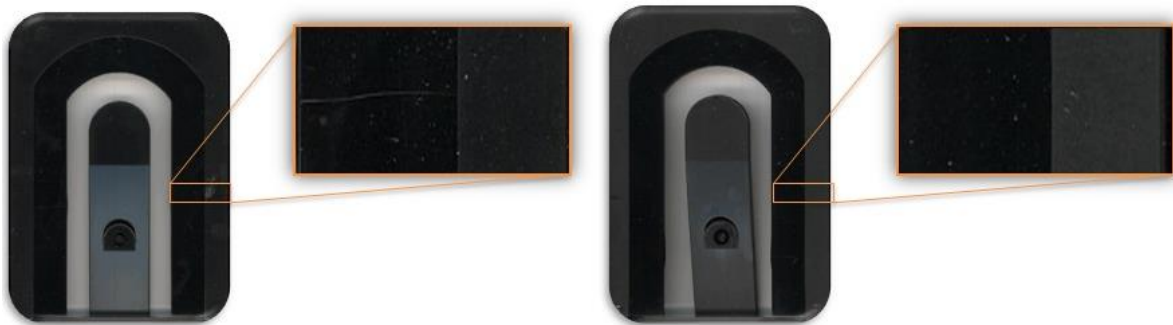
Figuur 39: Verschil in vloeilijn tussen variotherm (links) – en hybride variotherm spuitgieten (rechts)
