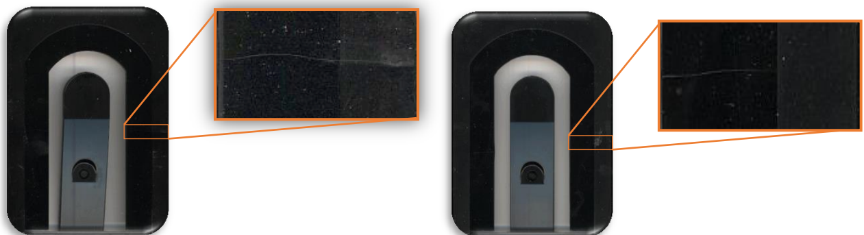
Figuur 31: Verschil met of zonder vloeilijn op het matte gedeelte
