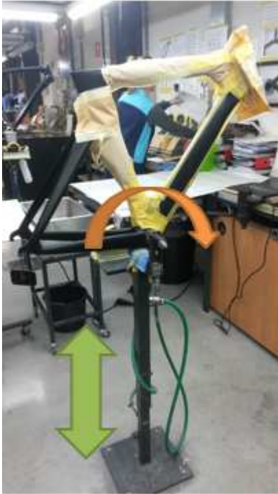
Figuur 14: Draaien rond trapas en in hoogte verstelbaar
