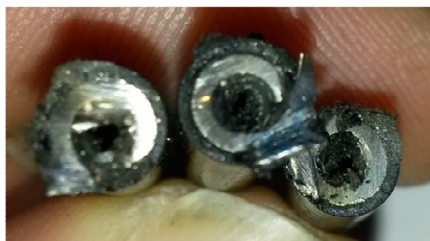
Figuur 81: Slecht geslepen kabel
