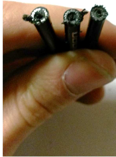
Figuur 59: Gemiddeld aantal bramen + matige snede
