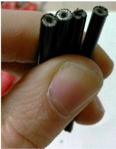
Figuur 60: Score van 7 op bramen en snede
