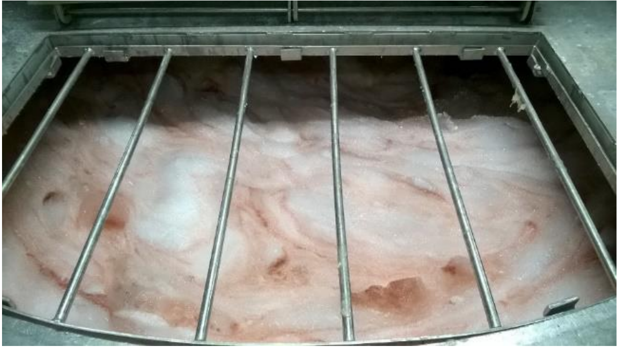
Figuur 14: Opperolakteschuim na grondstoftoediening onder vloeistofniveau
