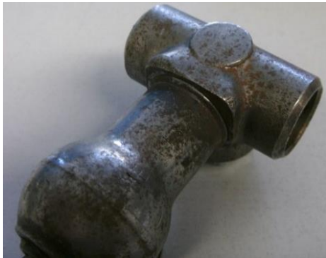
Figuur 22: Gecorrodeerde connector
