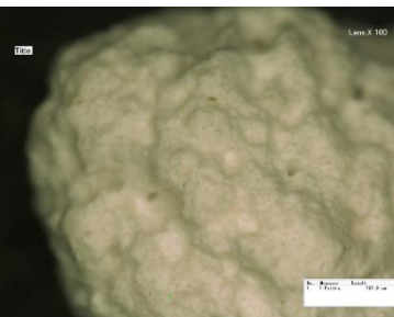
Figuur 19: Oppervlak van een METEX-korrel.
