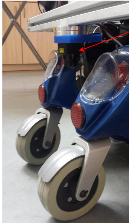
Figuur 18: De laserscanner werd ondersteboven gemonteerd aan de achterzijde van de rolstoel.
