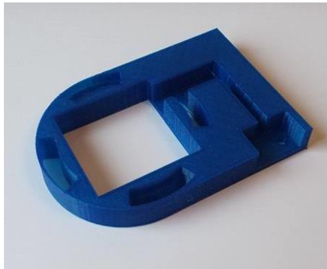
Figuur 20: 3D geprint beschermblokje dat ontworpen werd ter beveiliging van de laserscanner..
