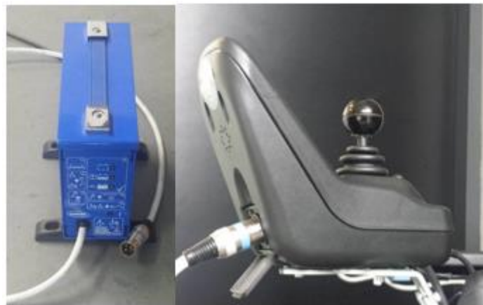
Figuur 2: Rolstoelbatterijlader met connector voor de gebruikte Invacare rolstoel (links). De lader vormt de wisselspanning van het net (230 V) om tot gelijkspanning voor de in serie geplaatste rolstoelbatterijen (2 x 12 V), en detecteert ook wanneer de batterijen volledig opgeladen zijn. De rechtse figuur toont de laadstationconnector bevestigd aan de achterkant van de joystick.
