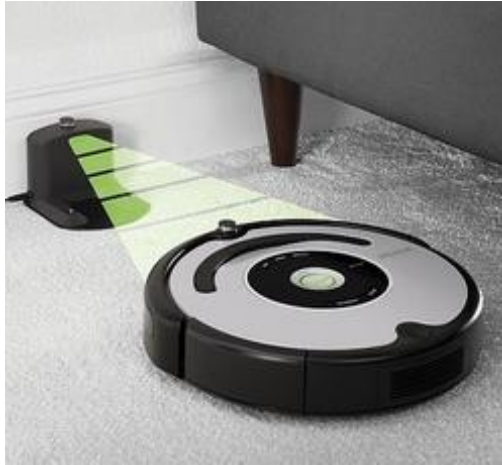
Figuur 6: Detectie van het laadstation a.d.h.v. infrarood sensoren [5].
