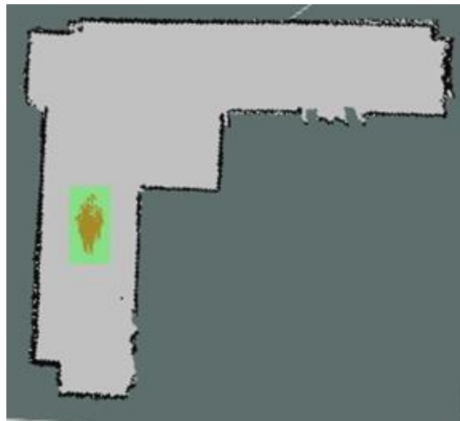
Figuur 36: Eindtoestand AMCL, de rechthoek stelt de geschatte pose van de rolstoel weer met de grootste waarschijnlijkheid. De rode pijltjes stellen de andere geschatte poses voor.
