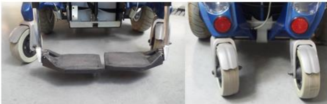
Figuur 8: De voetplankjes van de rolstoel aan de voorzijde (links) en de zwenkwieken van de rolstoel aan de achterzijde (rechts) geven problemen bij het aanmeren bij het ontwerp van sectie 2.2.2.1.
