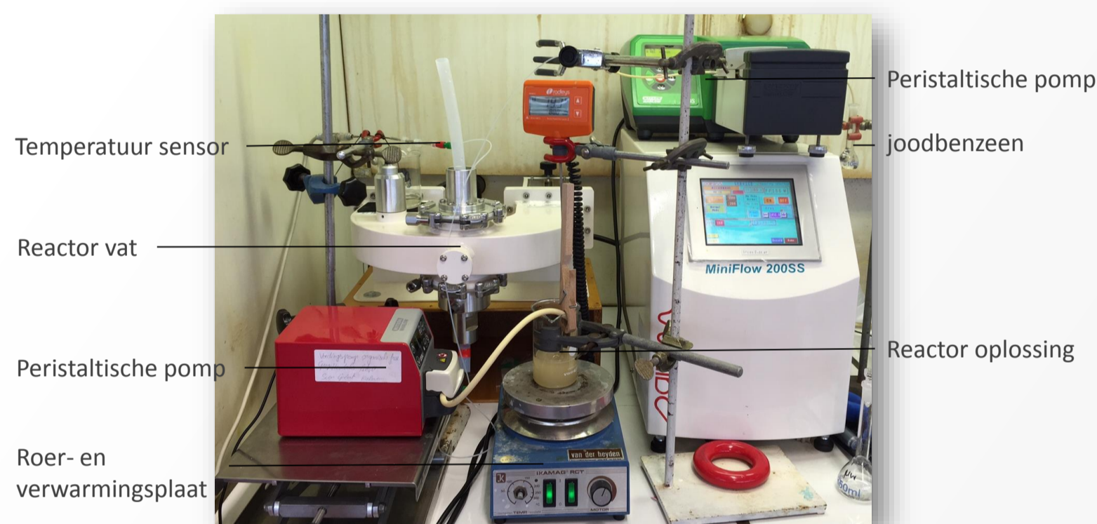
Figuur 3: Opstelling microgolf-geassisteerde flow
