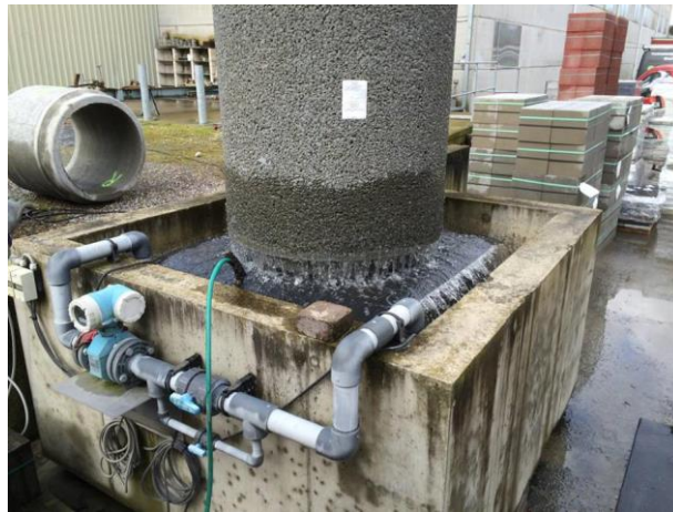
Figuur 11: Proefopstelling infiltratieproef
