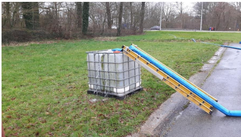
Figuur 19: Proefopstelling debietmeting pomp
