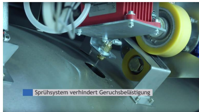
Figuur 5: Sproeisysteem tegen stank en aandrijving door wiel en tegenwiel tegen rail
