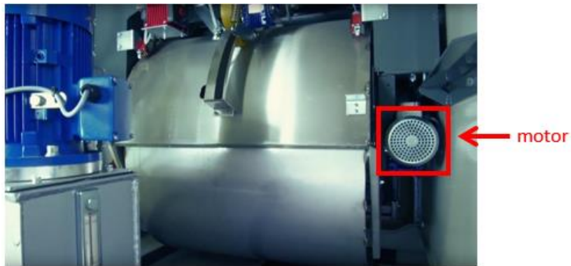
Figuur 4: Trommelbeladingsysteem Pöttinger, langs binnenkant container bekeken
