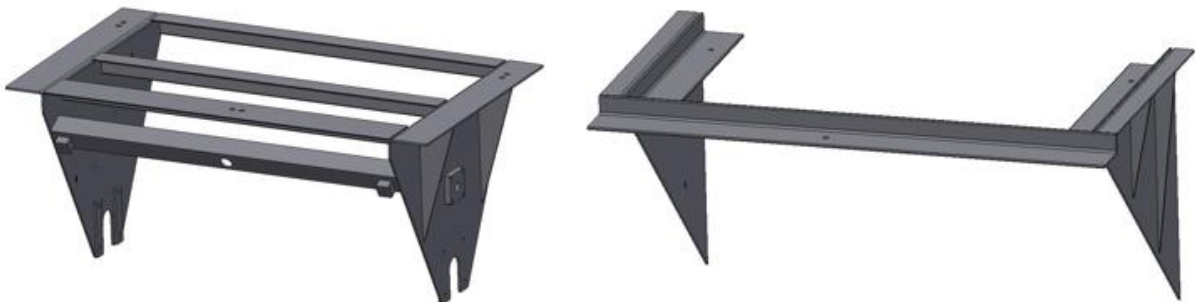
Figuur 21: Ophanging van trommels en ophanging aan deur (van links naar rechts)
