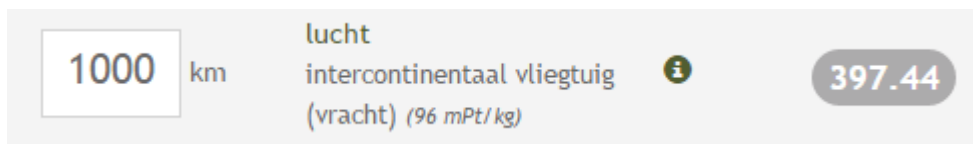
Figuur 76: milieu-impact voor 1000km luchttransport voor een frameforkset van 2kg in de nieuwe verpakking
