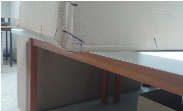
Figuur 61:foto van de doos na de testen
