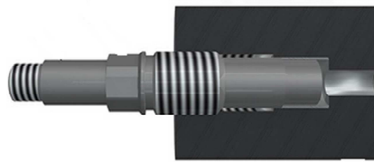
Figuur 23: Met uitsparing (Recessed mount) [13]
