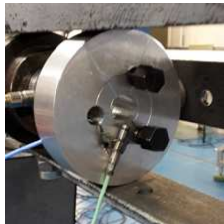
Figuur 34: Sensorpositie achter de schijf
