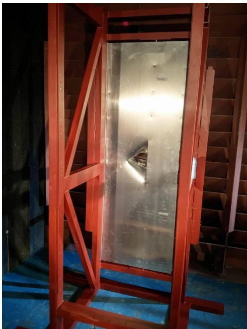
Figuur 16: Duidelijke perforatie van de treindeur
