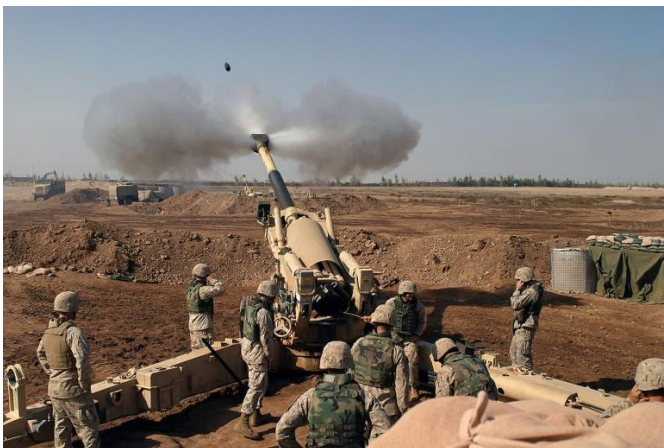
Figuur 11: De mondingsrem van een M198 houwtiser blaast het drijfgas zijwaarts af, waardoor de terugslagenergie verkleind wordt [10]
