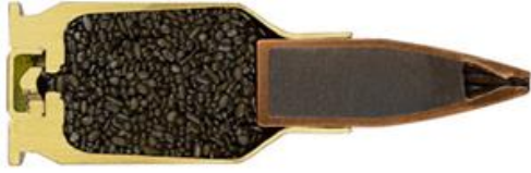
Figuur 13: Doorsnede kogel waar het kruit links te zien is [12]
