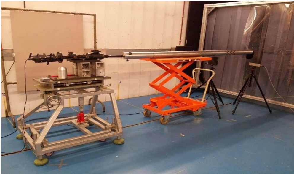
Figuur 15: Opstelling kruitkanon met meetapparatuur
