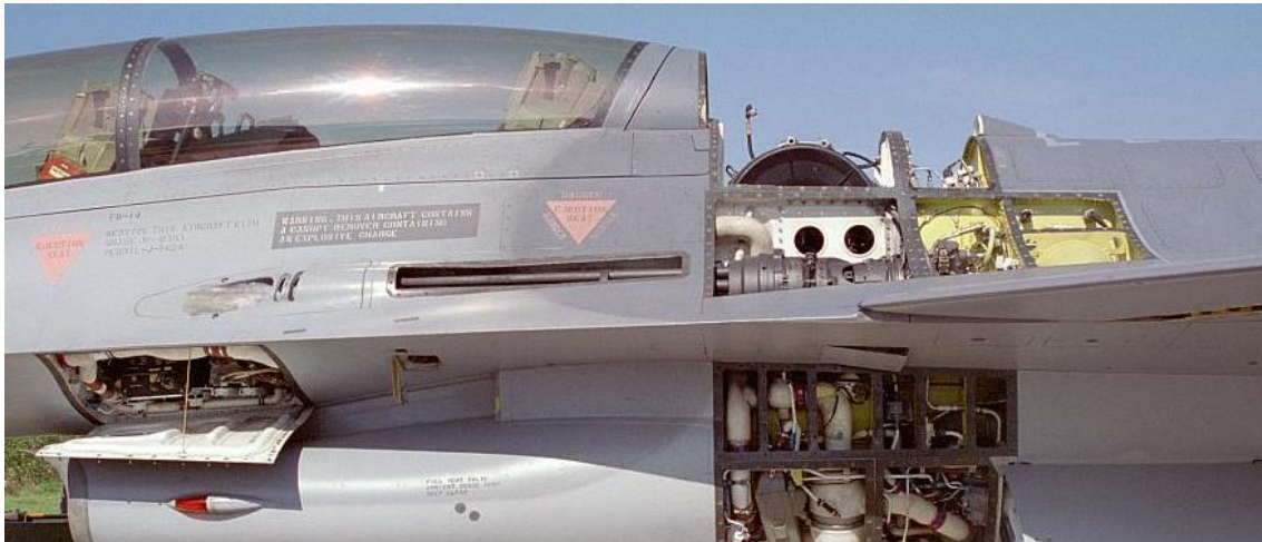
Figuur 4: M61 Vulcan 20 mm geplaatst in een F-16 straaljager van de Belgische luchtmacht [4]
