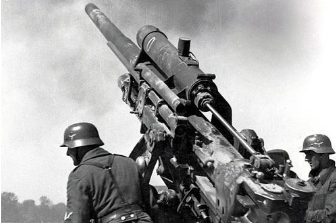
Figuur 12: Duits 88 mm kanon, hier is duidelijk het hydropneumatische terugslagsysteem te zien dat zich boven en onder de loop bevindt [11]
