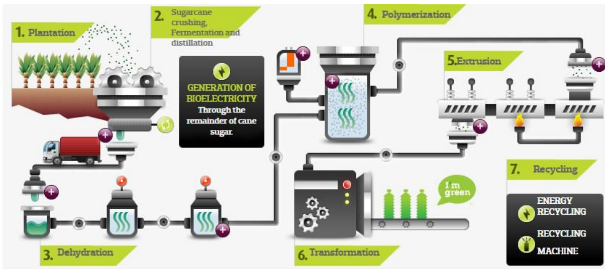
Figuur 40 Productieproces Green polyethylene (Braskem, n.d.)
