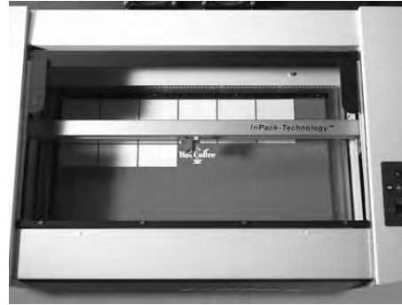
1.8 Trotec, CO 2 Lasersnijmachine, Speedy 100, werkbereik: 610 x 305 mm – laservermogen: 12-60 Watt.
