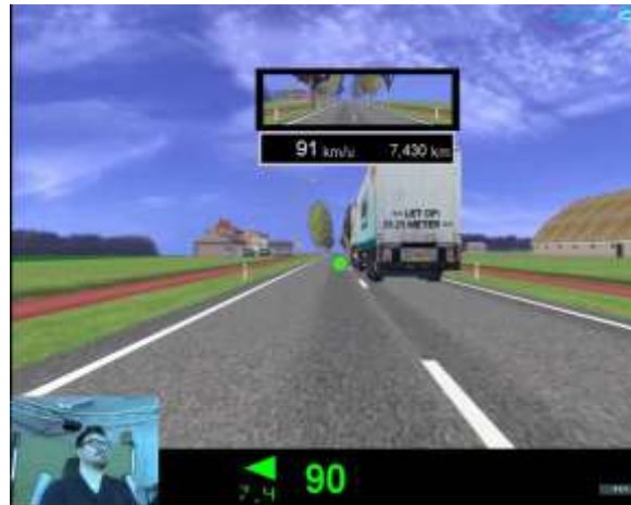
Figuur 9: Waarschuwbord op de achterzijde van de LZV
