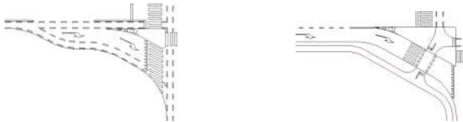
Figuur 1: De twee types van bypass-ontwerp, gebaseerd op de aanbevelingen van het AWV (2009).
