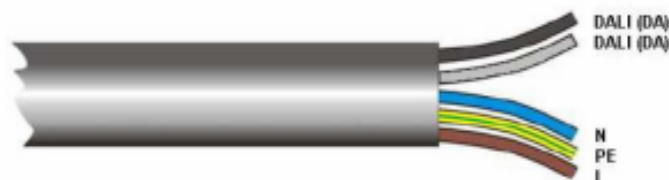
Figuur 55: Vijf aderige kabel met DA- en DA+ [53]
