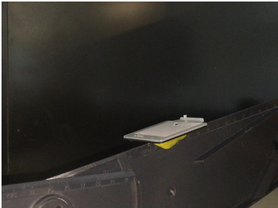
Figuur 73: Druppel op getextureerd oppervlak bij helling van 15^\circ
