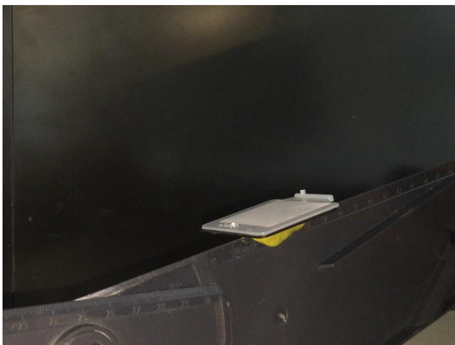
Figuur 75: Druppel op getextureerd oppervlak bij helling van 16^\circ
