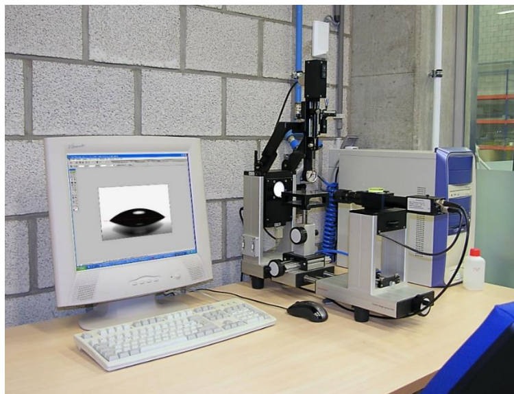
Figuur 39: Meetopstelling contacthoekmeter
