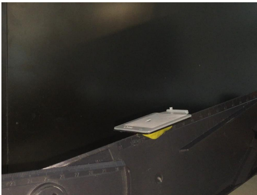
Figuur 74: Rollende druppel op getextureerd oppervlak bij helling van 16^\circ
