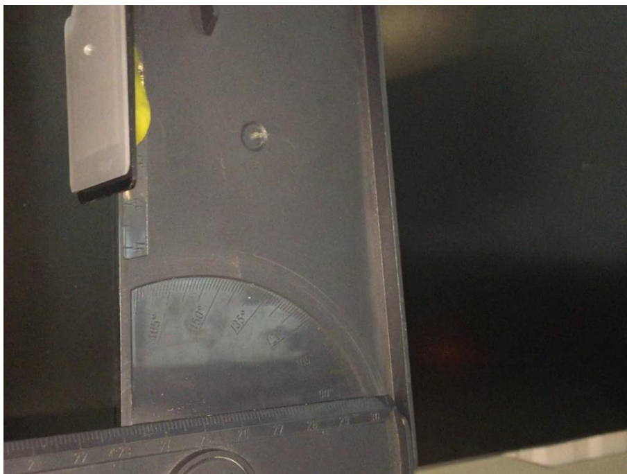
Figuur 71: Druppel op ongetextureerd oppervlak bij helling van 90^\circ
