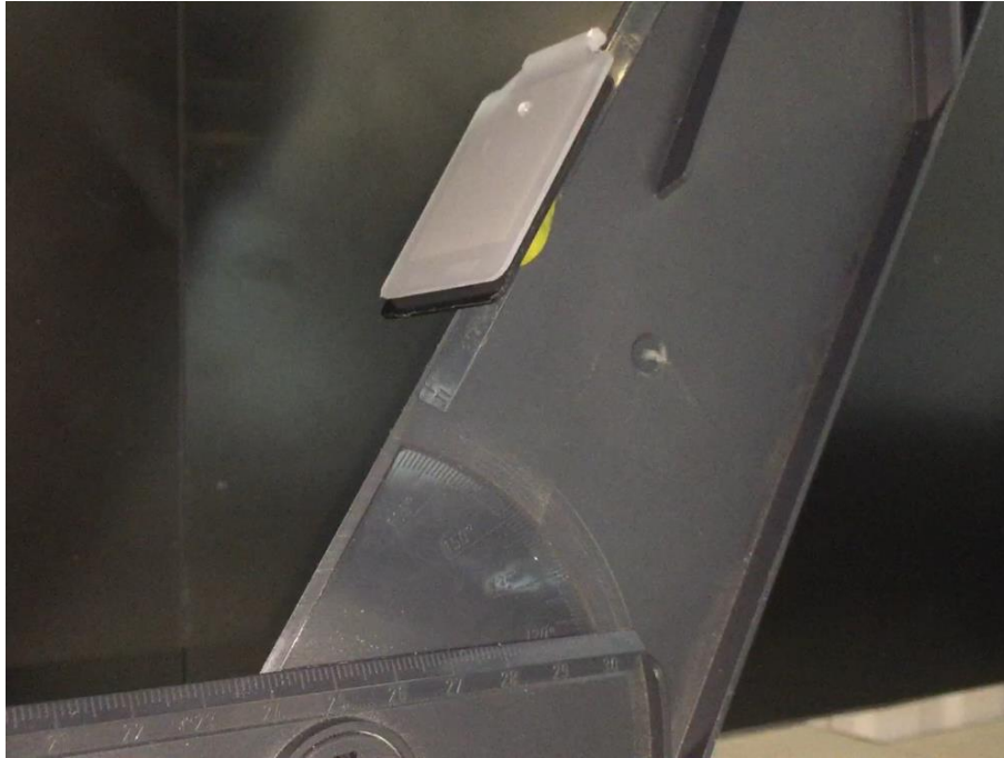
Figuur 70: Druppel op ongetextureerd oppervlak bij helling van helling van 75^\circ
