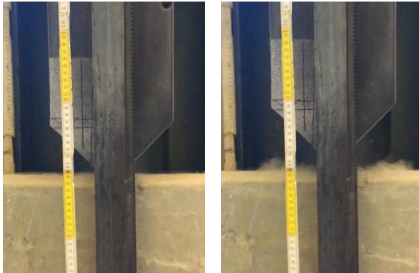
Figuur 22: Doorbuiging en rebound samenstelling 1
