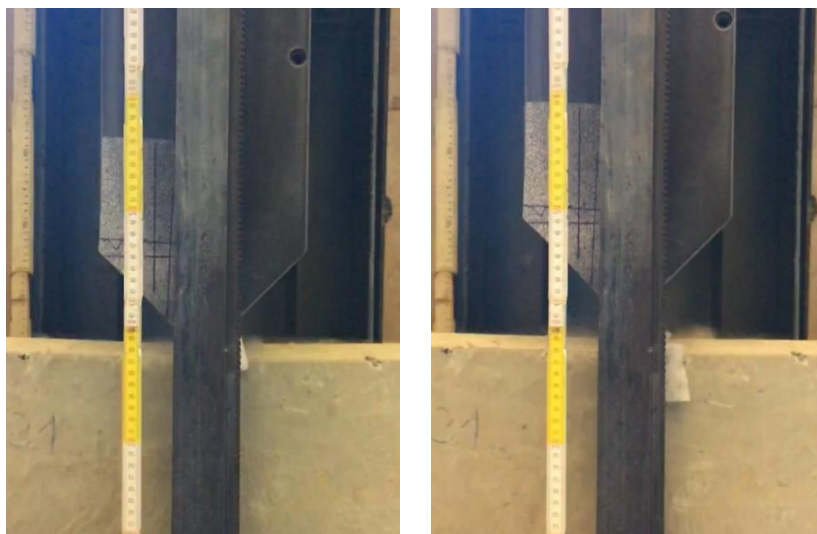
Figuur 24: Doorbuiging en rebound samenstelling 3
