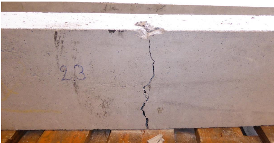
Figuur 21: Schadepatroon proefstukken
