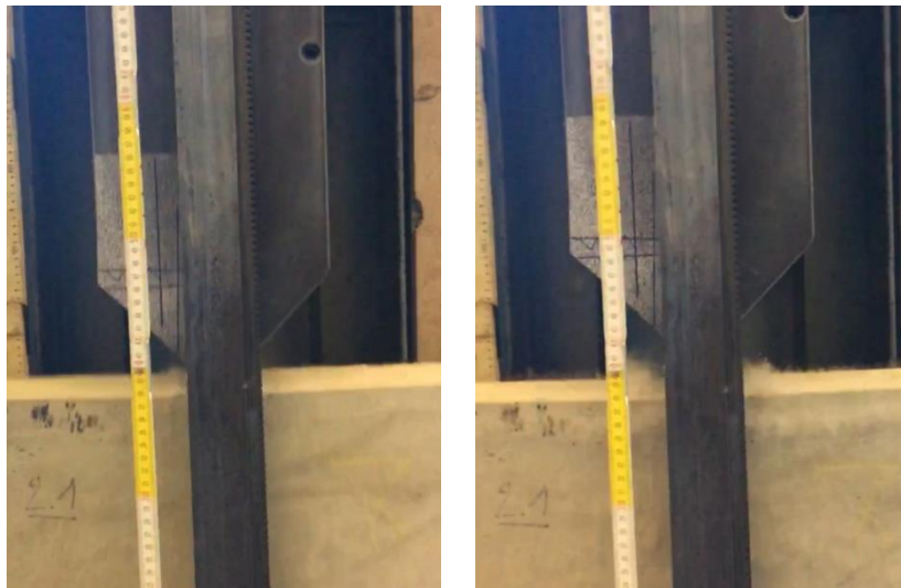
Figuur 23: Doorbuiging en rebound samenstelling 2
