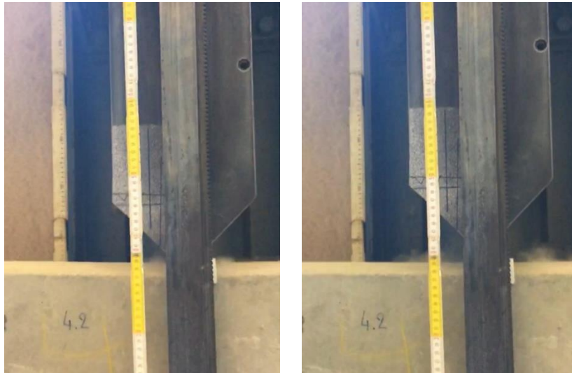
Figuur 25: Doorbuiging en rebound samenstelling 4
