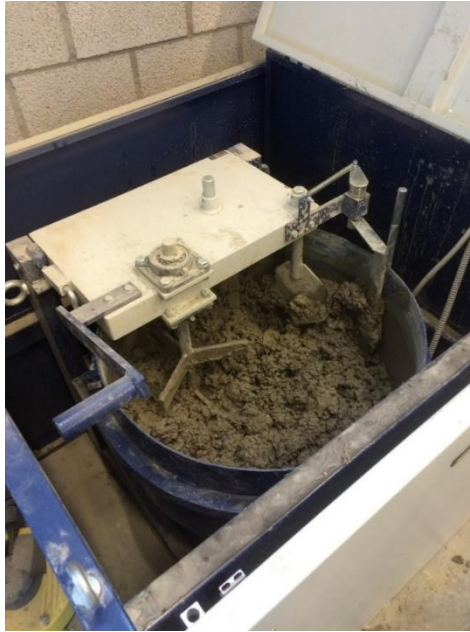
Figuur 9: Het mengen van beton
