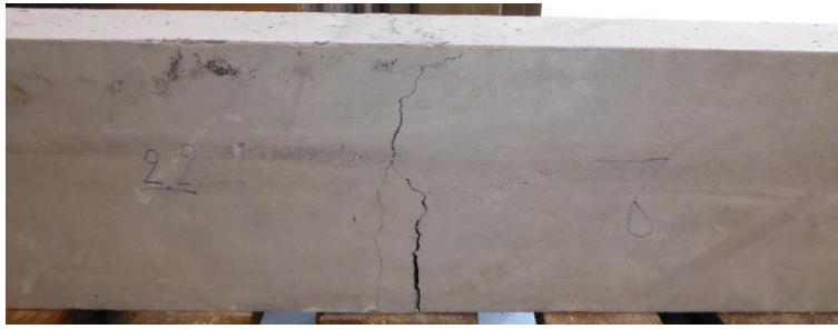
Figuur 28: Schadepatroon proefstuk van samenstelling 2
