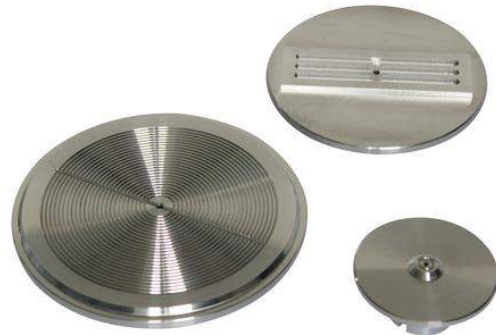
(b) Chucks op vacuüm voor verschillende substraatvormen. [44]
