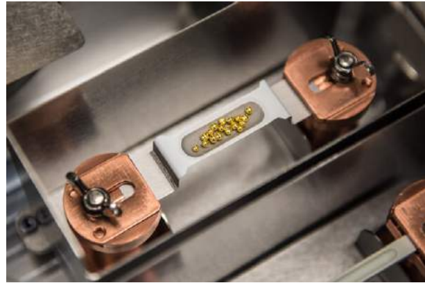
(b) Source boat gevuld met goudkorrels.
