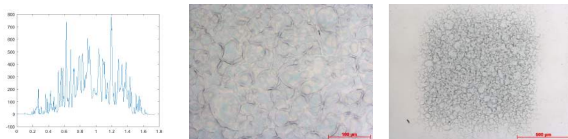
(a) PEDOT:PSS-pixel van 1 mm - profilometrie (b) PEDOT:PSS-pixel van 1 mm (20x) (c) PEDOT:PSS-pixel van 1 mm (5x)
