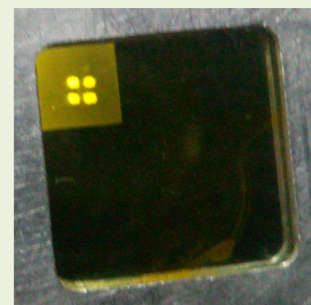
Figuur 6: OLED met ultrasoon gespraycoate en gepixelde Hole Transport Layer (0,5 mm).
