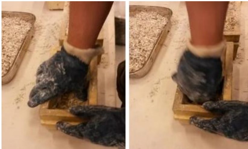
Figuur 69: Los (links) en vast (rechts) verdichten mengsel in de mal
