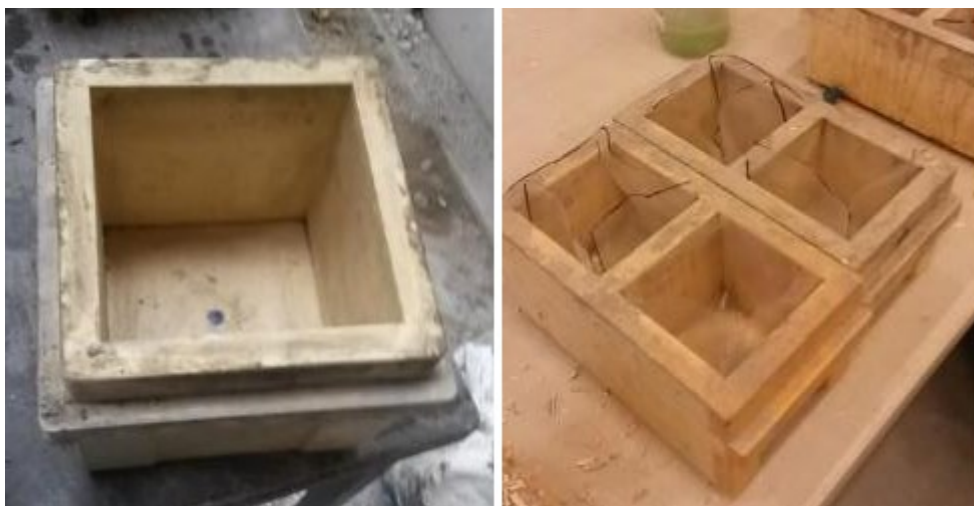
Figuur 68: Kubusvormige mallen zijden 150 mm (links) en 100 mm (rechts)
