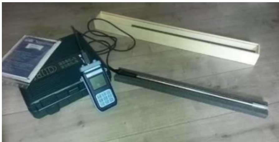
Figuur 47: Hygro-thermometer met pt100 sensor
