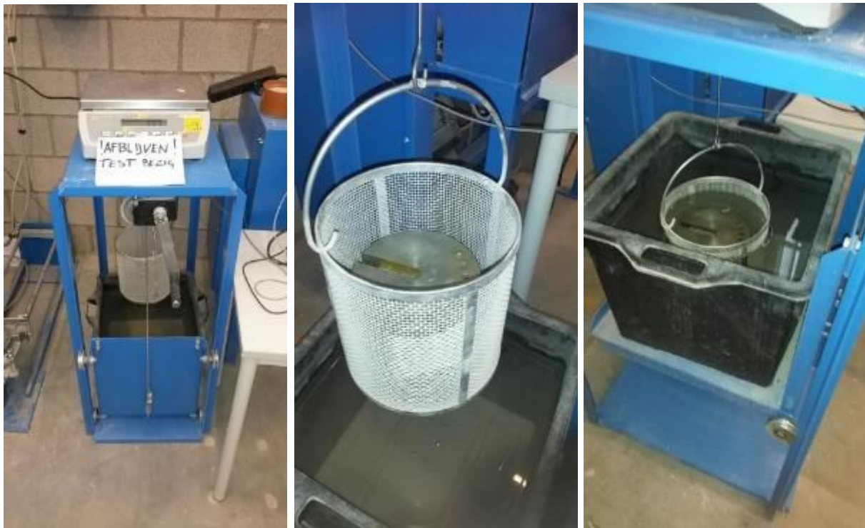
Figuur 73: a) drijfvermogen balans systeem, b) korf en c) onderdompelen korf
