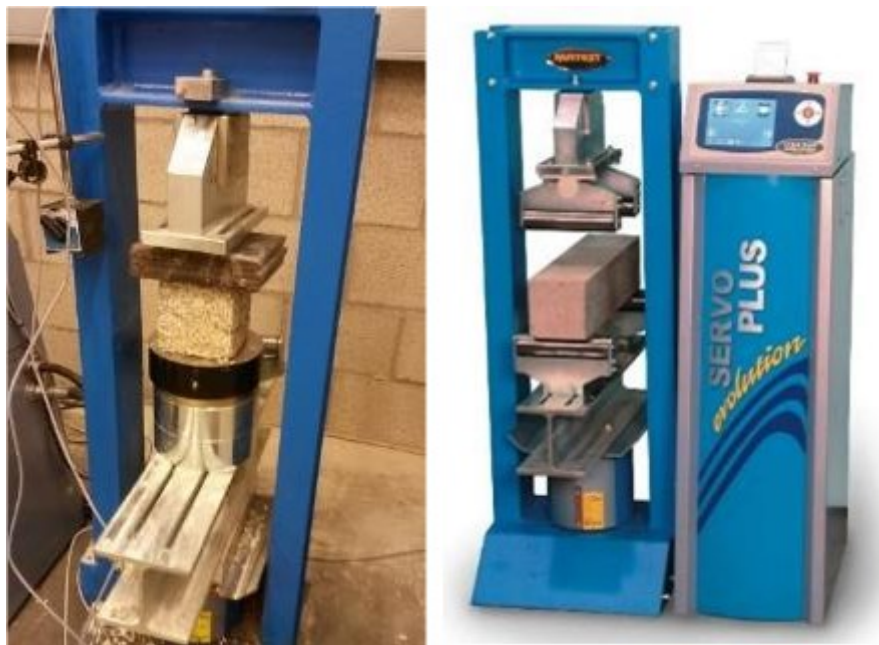
Figuur 71: Druk- en buigbank voor het drukken van de monsters [76]
