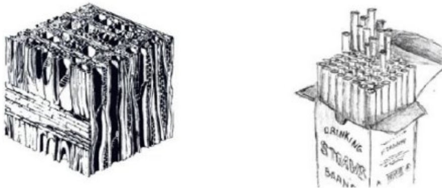
Figuur 20: Celstructuur houtvezel vergelijkbaar met drinkkrietjes [28]
