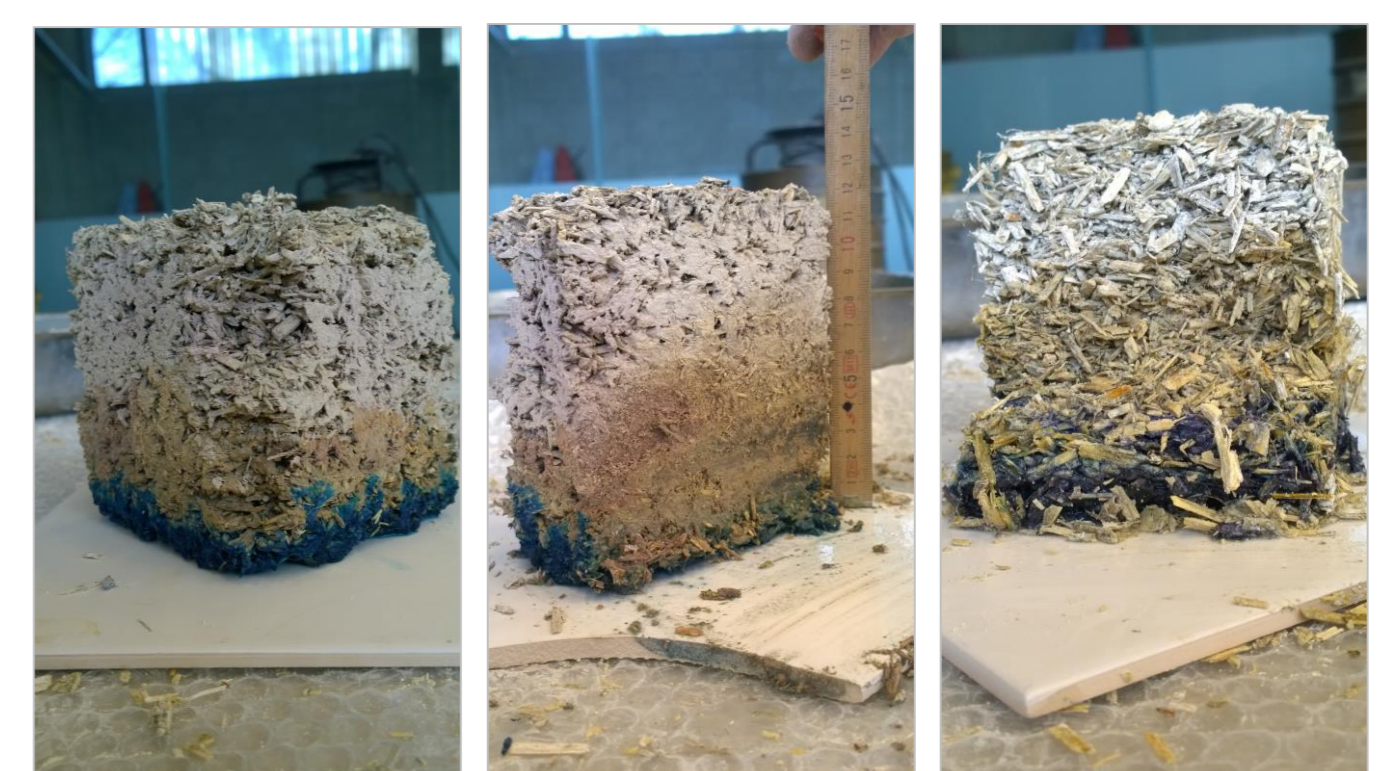
Figuur 4: Stijghoogte water in kalkhennepmonsters
