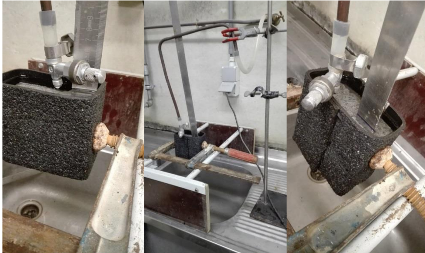
Figuur 41: Opstelling waterdoorlatendheidsproef van het beton van de Fluvio-blok
