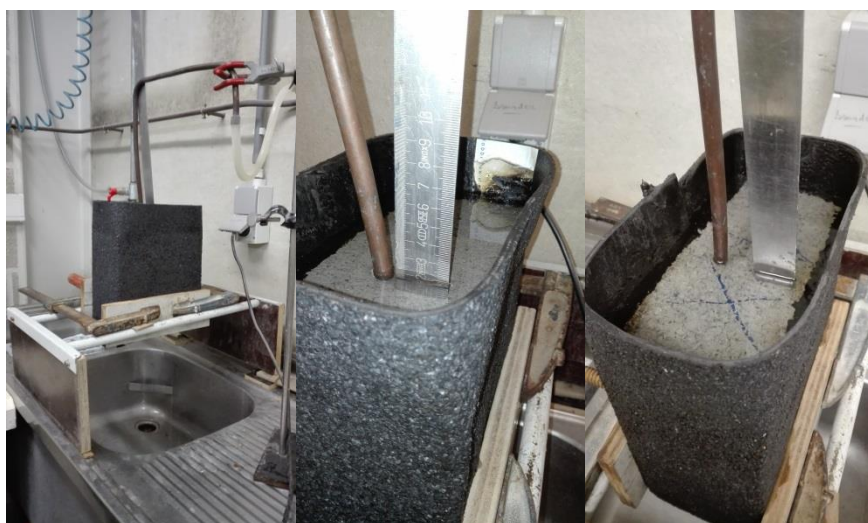
Figuur 44: Proefopstelling waterdoorlatendheidsproef van een volledige Fluvio-blok Type80
