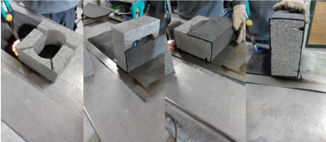
Figuur 43: Het proces van het omdoen van de roofingband
