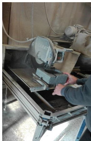
Figuur 39: Zagen van het proefstuk
