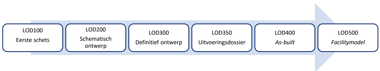
Figuur 12: Evolutie van LOD in functie van de vordering van het bouwtraject
